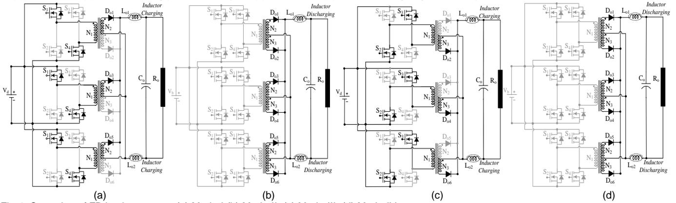
Fig. 4. Operation of FB buck converter (a) Mode-I (b) Mode-II, (c) Mode-III, (d) Mode-IV.
