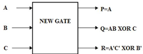
Fig. 7. Block diagram
