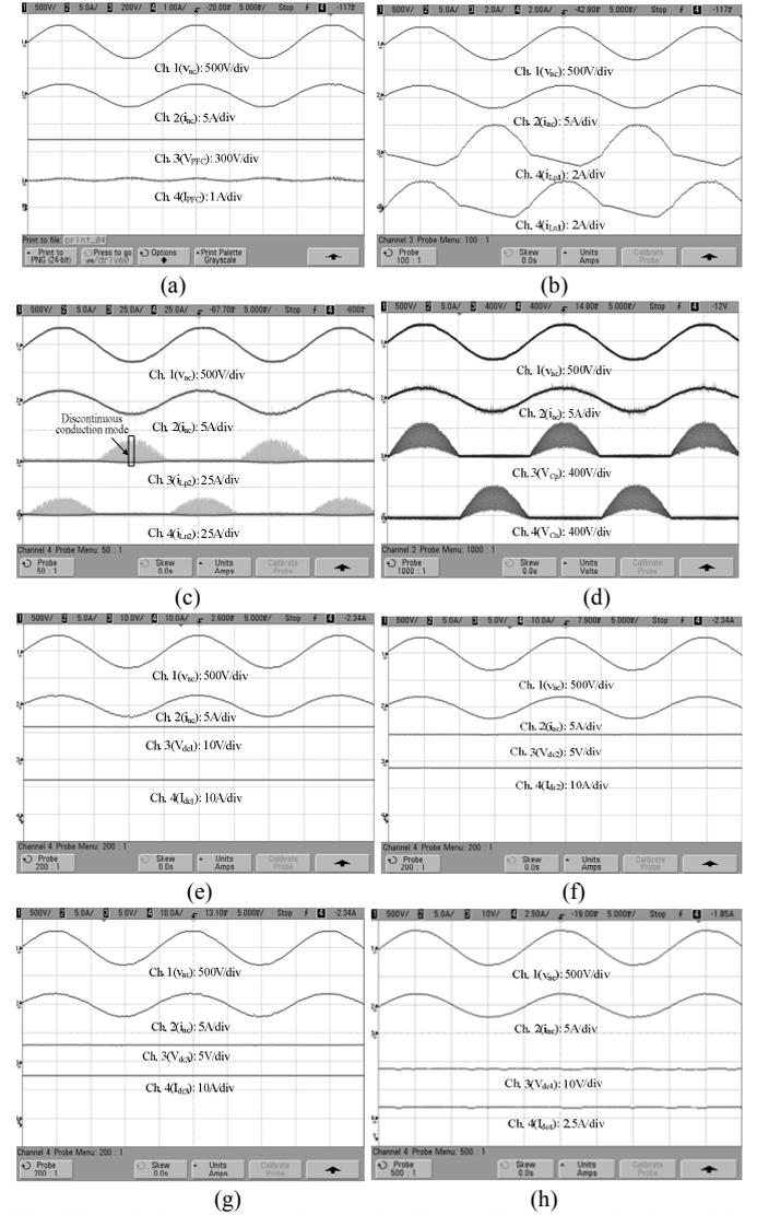
Fig. 7 Recorded waveforms of (a)  $v_{ac}$ ,  $i_{ac}$ ,  $V_{PFC}$  and  $I_{PFC}$ , (b)  $v_{ac}$ ,  $i_{ac}$ ,  $i_{Lp1}$  and  $i_{Ln1}$ , (c)  $v_{ac}$ ,  $i_{ac}$ ,  $i_{Lp2}$  and  $i_{Ln2}$ , (d)  $v_{ac}$ ,  $i_{ac}$ ,  $V_{Cp}$  and  $V_{Cn}$ , (e)  $v_{ac}$ ,  $i_{ac}$ ,  $V_{dc1}$  and  $I_{dc1}$ , (f)  $v_{ac}$ ,  $i_{ac}$ ,  $V_{dc2}$  and  $I_{dc2}$ , (g)  $v_{ac}$ ,  $i_{ac}$ ,  $V_{dc3}$  and  $I_{dc3}$ , and (h)  $v_{ac}$ ,  $i_{ac}$ ,  $V_{dc4}$  and  $I_{dc4}$
